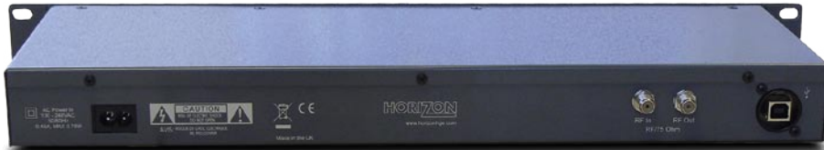
Stražnja ploča čitača transponder streama sa drugim brzim USB sučeljem i antenskim ulazom. Za sve ostalo brine se adaptirani softver TSReader Roda Hewitta
