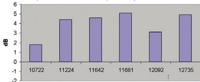
Pojačanje na izlazima za prijemnike. Transponderi s horizontalnom polarizacijom.
