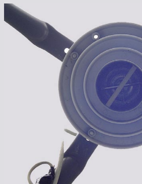
▲ Pogled u otvor feeda: jasno se može prepoznati dielektrik neophodan za prijem kružno polariziranih signala. Ukoliko ga uklonite, LNB će biti prilagođen prijemu linearne polarizacije.
