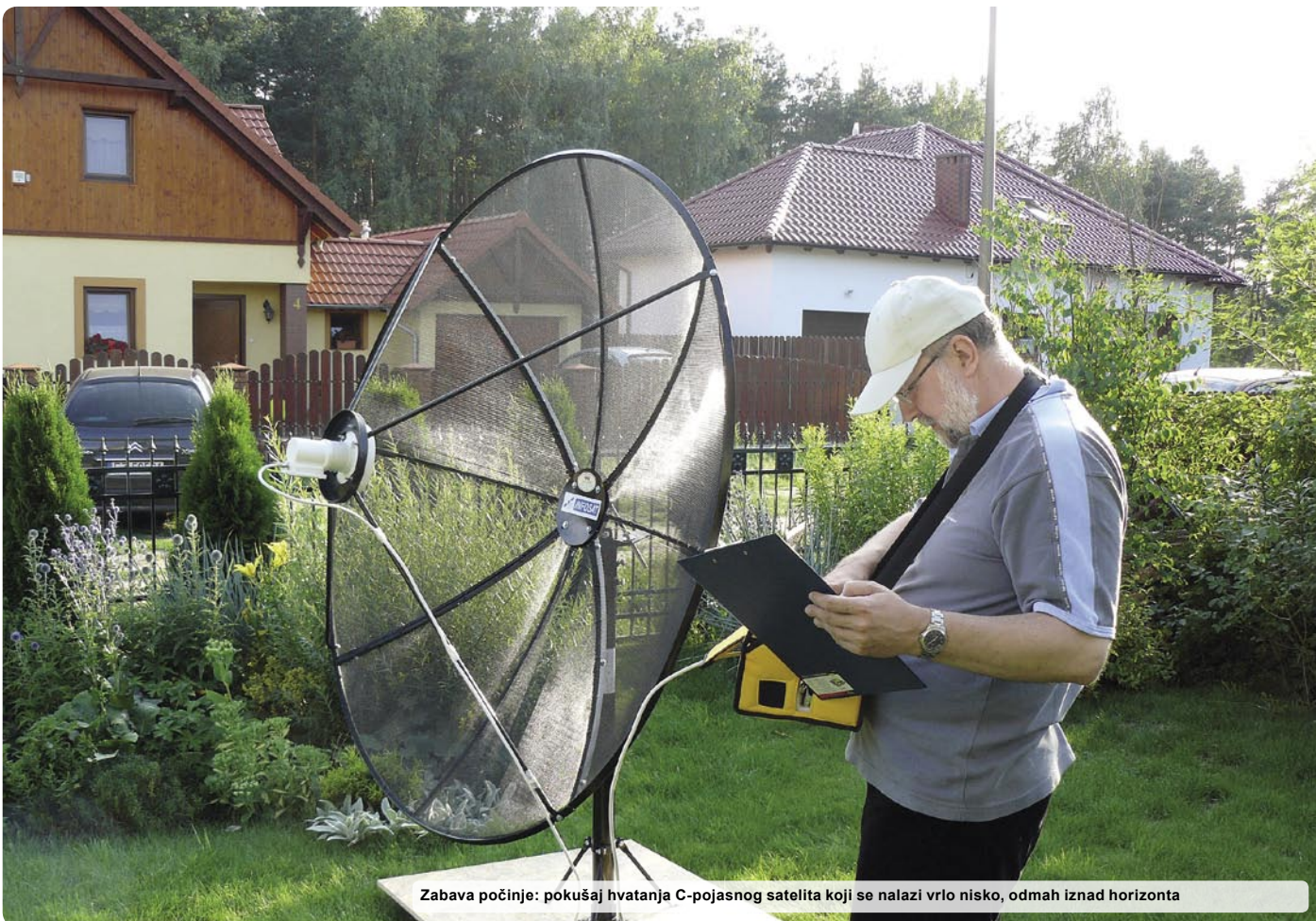
Sada treba usmjeriti antenu Preporučujemo korištenje libele s kutomjerom. Zahvaljujući njoj, lakše ćete podesiti kut elevacije.
