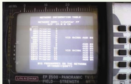
■ Diegov mjerča satelitskog signala prikazuje NIT tablicu jednog od transpondera na satelitu EHOSTAR 6A koji prima
