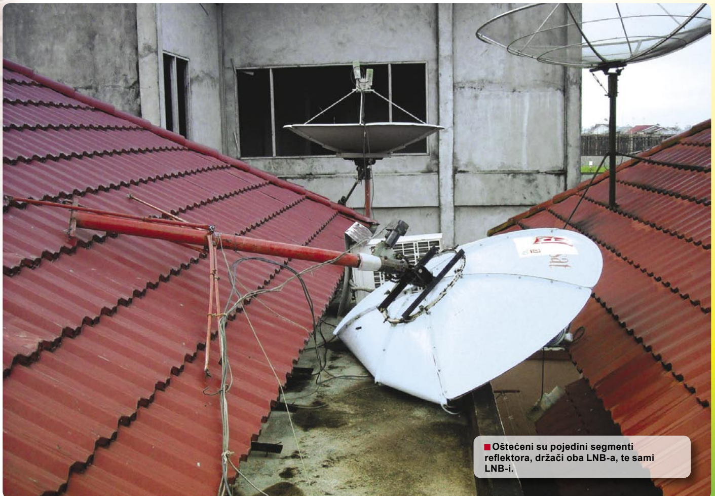
■ Sada: Tužan prizor: antena od 1,8 m srušila se uslijed prejakog vjetra.
