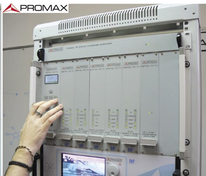
■ Teoriju demonstriraju stvarni uređaji: u svakom ležištu nalazi se jedan mogući izvor signala. Na kraju se dobiva zajednička priprema signala u DVB-T standardu.
