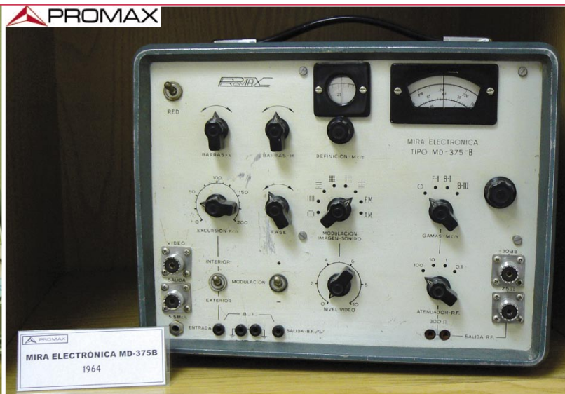
■ Jedan od prvih proizvoda tvrtke PROMAX: generator testnog signala iz 1964. godine
