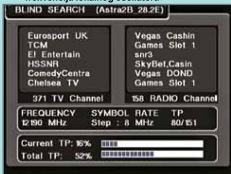
Pretraga na slijepo omogućuje detekciju transpondera koji se ne nalaze na tvornički memoriranom popisu |
