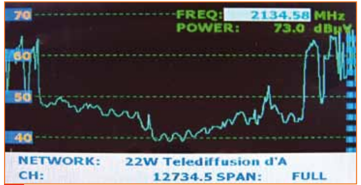
Spektar satelita NSS7 na 22° zapadno s Invacom LNB-om |
