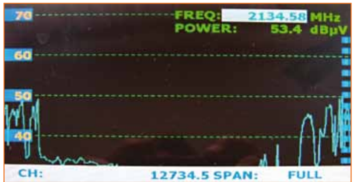
Spektar satelita NSS7 na 22° zapadno s koaksijalnim LNB-om |
