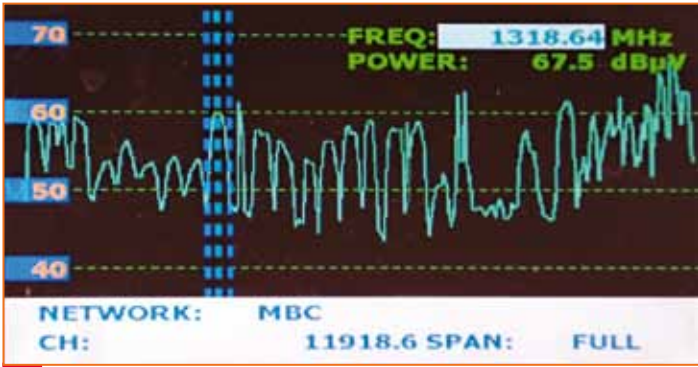
Spektar satelita BADR na 26° istočno s Invacom LNB-om |
