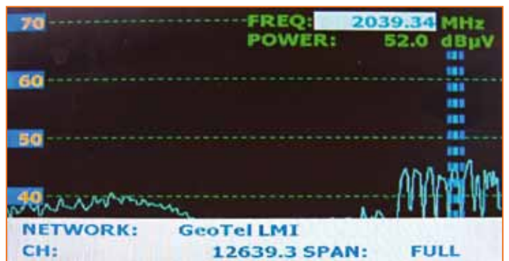
Spektar satelita ABS1 na 75° istočno s koaksijalnim LNB-om |
