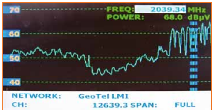
Spektar satelita ABS1 na 75° istočno s Invacom LNB-om |
