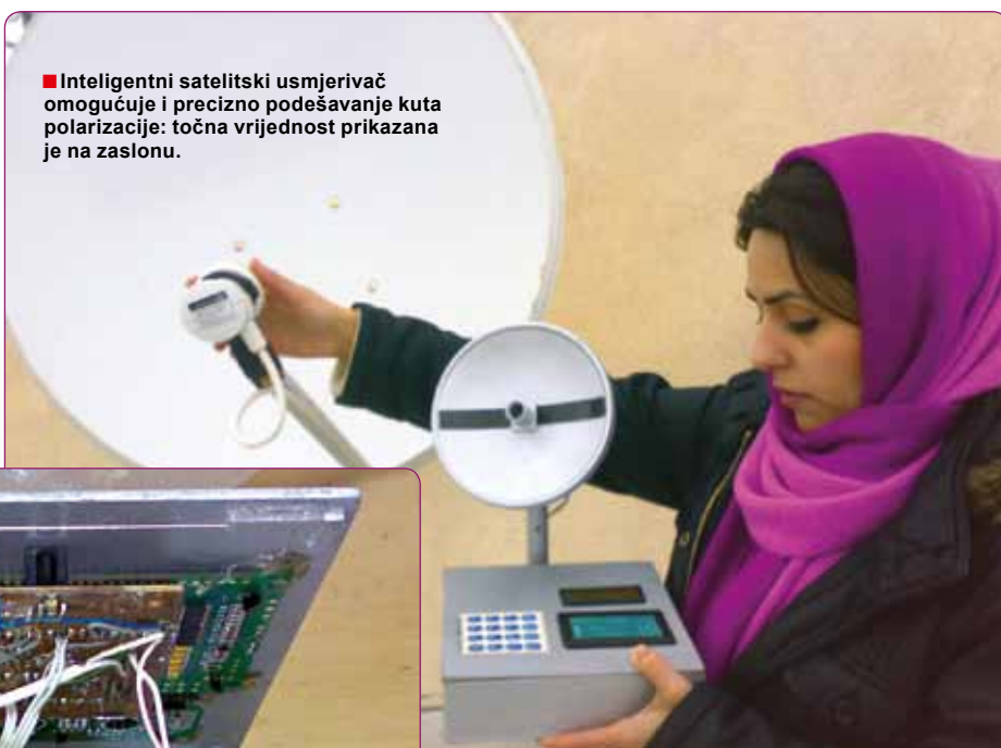
■ Ovako se koristi inteligentni satelitski usmjerivač: on pokazuje poziciju satelita koji se žele uhvatiti, a stvarna antena se jednostavno postavi paralelno s njim.
