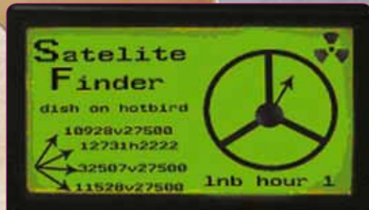
■ Zaslon inteligentnog satelitskog usmjerivača s prikazom najjačih transpondera i kuta polarizacije LNB-a.
