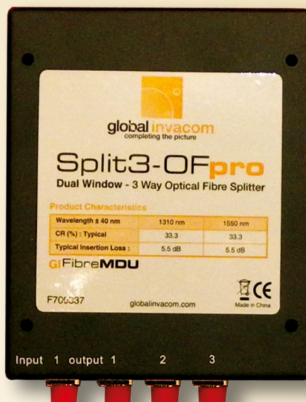
■ GlobalInvacom je modificirao optički razdjelnik ugrađivši u njega priključke s konektorima: optičke kabele sada možete izravno utaknuti u razdjelnik.
